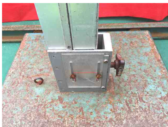
左の写真はネジが取れてしまい、修理した状態です。六角レンチで固定しています。
