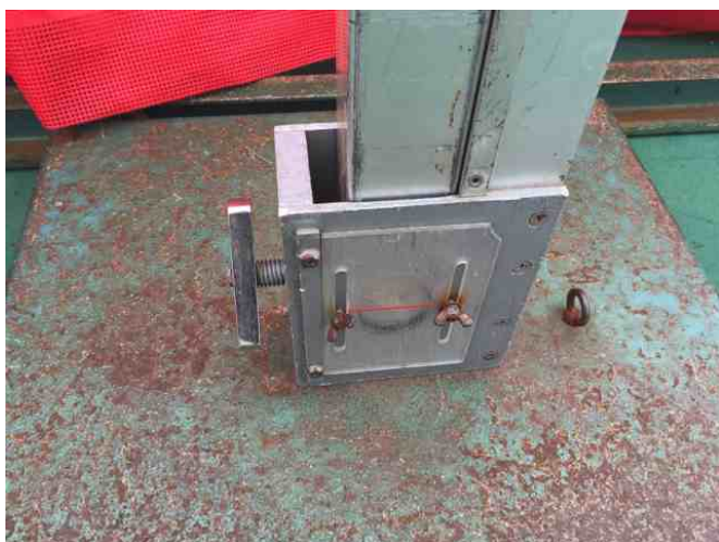
左の写真はネジが取れてしまい、修理した状態です。六角レンチで固定しています。
