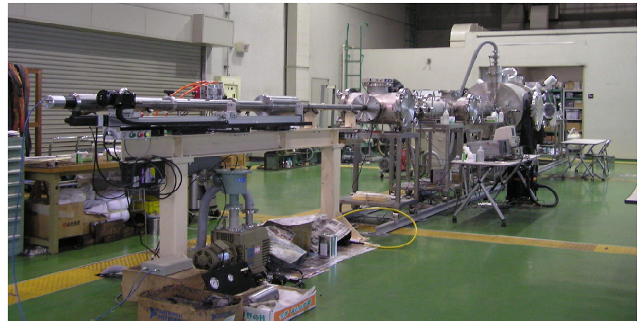
JAXA宇宙科学研究所の超高速衝突実験設備 (0.3gの物体を秒速5km以上に加速可能)
