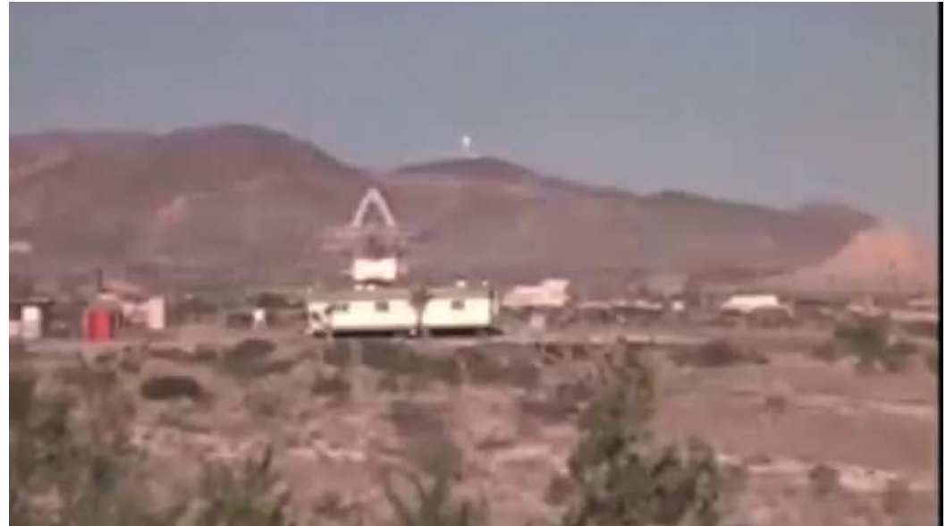
NASA JPLでのマイクロ波電力伝送実験(1.5km, 450kW送電、34kW受電、1975年)
