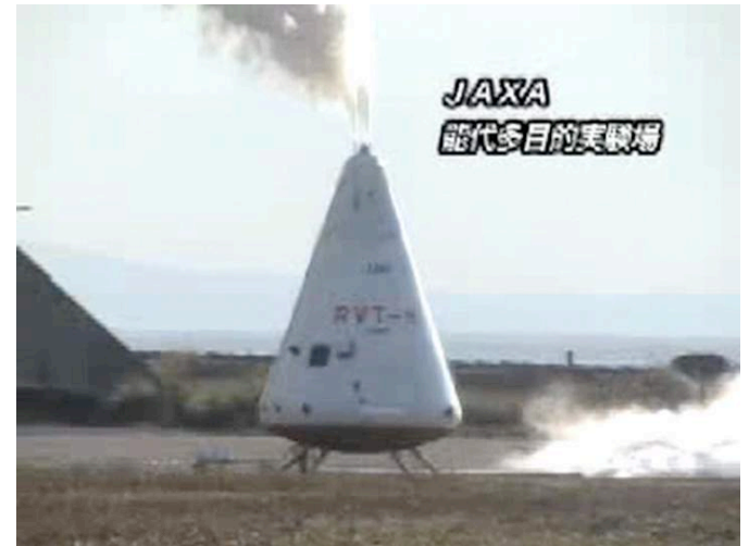
再使用ロケット実験機 重量:500kg、全長3.65m
