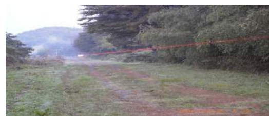
図5 地上のレーザー送電実験。約1kWのレーザービームを500m先の受電パネルに送電する。
