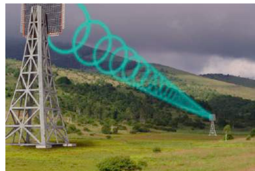
図4 地上のマイクロ波送電実験の構想。約3kWのマイクロ波ビームを100m先の受電パネルに送電する。
