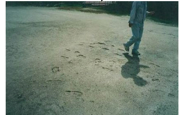
施工 1ヶ月後 改良部舗装と既設グラウンドの凍上と踏圧足跡の差異状況写真
